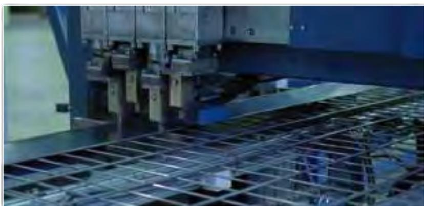
Après l'étape de tirage, le fil est découpé en barres de certaines longueurs. Les barres sont redressées afin de pouvoir poursuivre le processus dans la machine de soudage totalement automatique. Les barres sont apportées de la palette à l'unité de soudage où celui-ci est effectué par résistance. Au cours de ce processus, aucun additif n'est nécessaire. Les points de soudure sont très forts et les mailles soudées sont planes et de dimensions précises.
